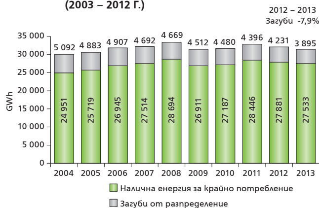
ФИГУРА 7. НАЛИЧНА ЕНЕРГИЯ ЗА КРАЙНО ПОТРЕБЛЕНИЕ И ЗАГУБИ ПРИ РАЗПРЕДЕЛЕНИЕТО В БЪЛГАРИЯ (2003 – 2012 Г.)
